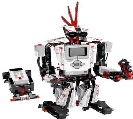
Şekil 5. LEGO Mindstorms EV3 kodlama eğitim robotu
